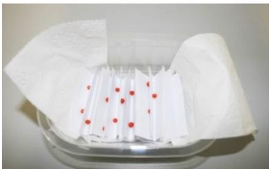
Platzieren Sie das gefaltete Filterpapier auf dem Papiertuch in der Plastischale und verteilen Sie 100 Pillen (je 2 Pillen je Falte, auf Lücke) in dem Faltenfilter.
